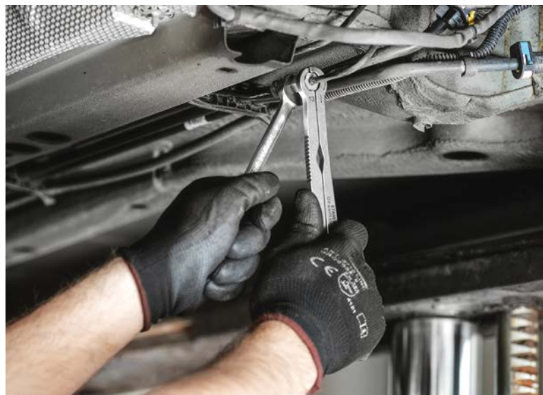
Der Stahlwille FastRatch 240 verbindet die Vorzüge eines Ratschenringschlüssels mit denen eines Maulschlüssels. (Fotos: Stahlwille)
