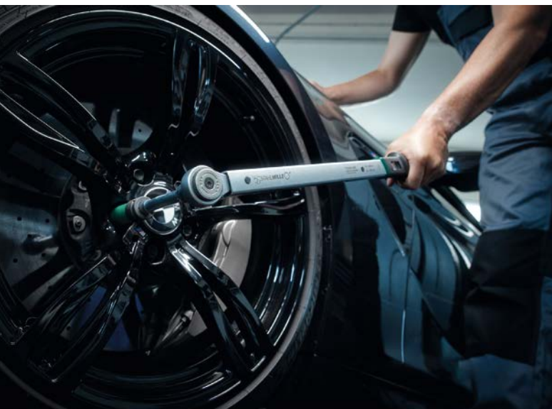
Mit dem Radmontage-Set 750NR/200/3/1 vom Werkzeugspezialisten Stahlwille sind Kfz-Werkstätten bestens gerüstet für den kontrollierten Schraubenanzug.
