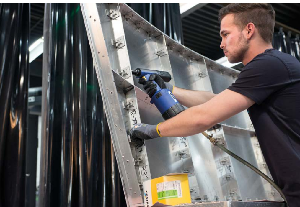
Die Taurus-Serie arbeitet mit Druckluft und ist für die stationäre Serienfertigung konzipiert.
