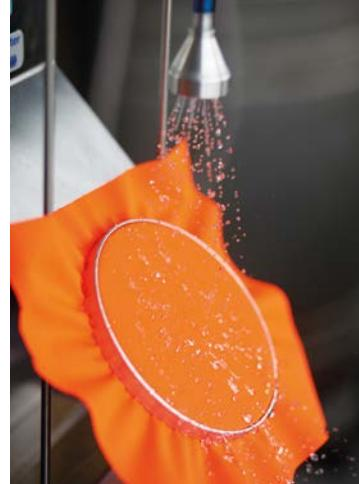
Mit dem Spraytest wird die Spraysdichtigkeit von Material und Verbindungen überprüft. Dadurch soll gewährleistet werden, dass die Kleidung einen Schutz vor flüssigen Chemikalien und Chemikalienspritzern bietet (hier im Bild ohne Farbstoff).
