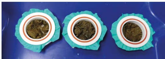
Als Permeation wird das Durchdringen einer Chemikalie auf molekularer Ebene durch das Material des Schutzhandschuhs bezeichnet. Zwei Faktoren werden dabei betrachtet: Wie schnell dringt die Flüssigkeit durch und in welcher Menge. Die Bilder zeigen Zustand eines Handschuhs vor und nach dem Einlegen in 98-prozentiger Schwefelsäure. (Fotos: Hohenstein)
