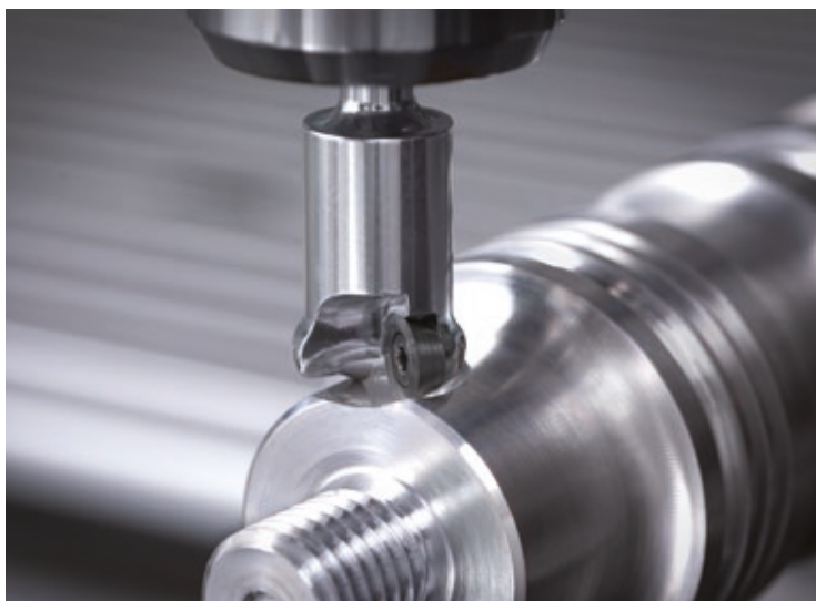
Der High Speed Torus Cutter ist ein einzigartiges Werkzeug für den Einsatz auf Robotern.
