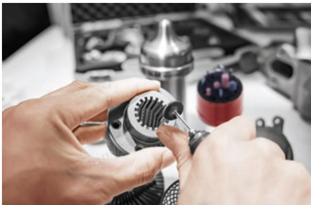
Das speziell konzipierte Easyfinish 3D-Werkzeugset mit zehn Spezialisten für die Nachbearbeitung.
