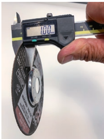
Die neue Magnum Precicut Trennscheibe ist „echte“ 1 mm dünn und ermöglicht exakte Schnitte frei Hand.
