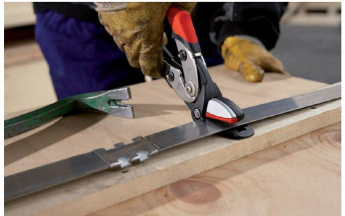
Die D1235 ist mit nur 260 mm Gesamtlänge die einzige, einhändig bedienbare Bandeisenschere auf dem Markt, die sogar gehärtete Stahlbänder (560 N/mm<sup>2</sup>) von 32 mm Breite und 1 mm Stärke durchtrennt.
