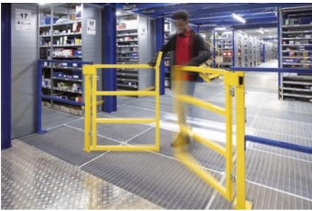
Speziell konstruierte Schwenktore wurden an den Palettenübergabestationen eingesetzt. (Fotos: Meta)
