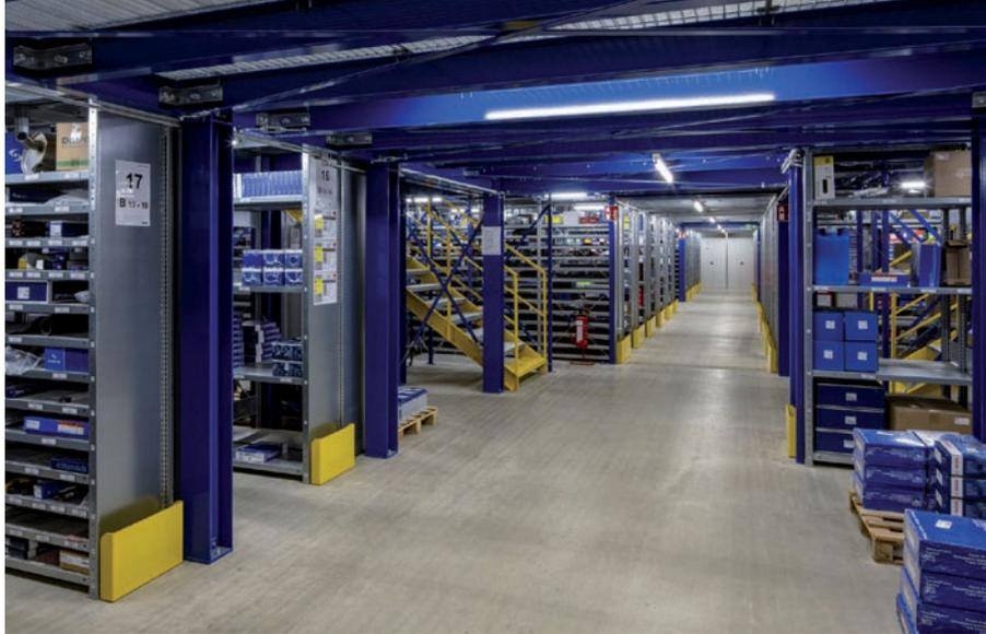
In enger Kundenabstimmung wurde eine neue dreigeschossige Fachbodenregalanlage auf Basis des Regalsystems META CLIP mit Stahlbaukomponenten realisiert.
