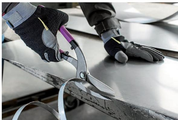
Hochleistungsscheren mit eingesetzten HSS-Schneiden zeichnen sich durch extreme Härte und Verschleißfestigkeit aus und erfüllen damit höchste Ansprüche an Standzeit sowie Schneidleistung.
