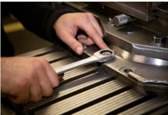
Die Ratsche mit 72 Zähnen hat einen Arbeitswinkel von 5 Grad und ermöglicht schnelles Lösen und Festziehen von Verschraubungen auch unter beengten Platzverhältnissen. (Foto: Stahlwille)
