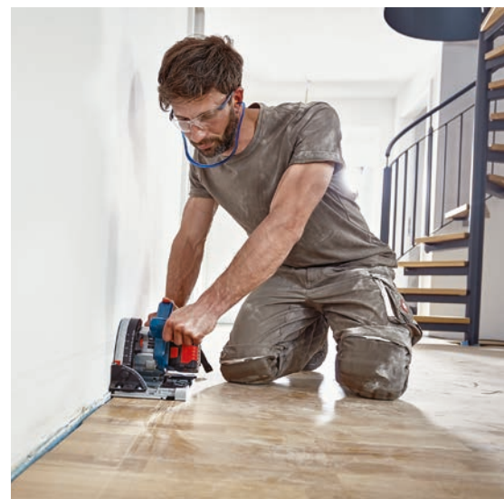
Mit der GKT 18V-52 GC Professional lässt sich extrem randnah arbeiten. (Fotos: Bosch)
